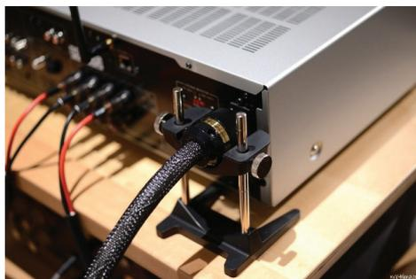
上蓋蓋上後，會更為穩固與具有更大的導振吸振作用，還可用隨附的橡皮圈將上下蓋綁住，綁住的方法可參照說明書。
