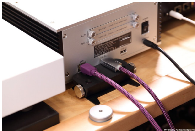
對於輸入端子較高位置的器材，NCF Booster Signal L可將兩根支柱安裝上去，利用旁邊兩個圓環轉動調整高度後鎖定。
